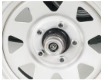
**Eje con lubricación E-Z**
